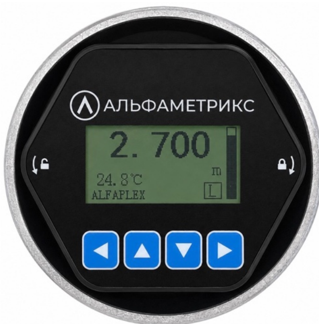
Рисунок 15 – Интерфейс управления уровнемером АльфаФлекс
